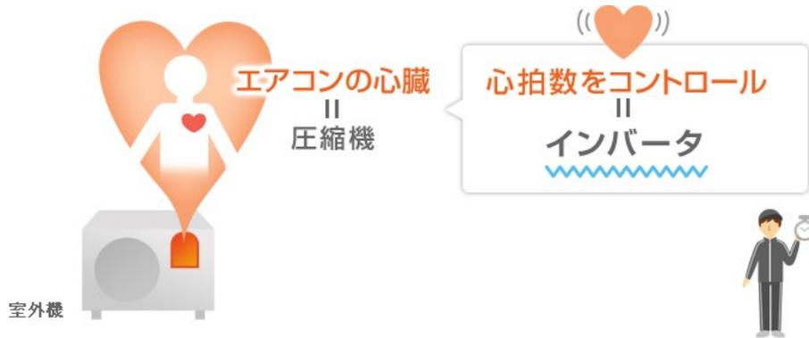
インバータにより、圧縮機の稼働状況を緻密に制御
